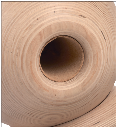
Das mit einer Korkschiicht angepasste Reflexrohr sorgt für die grundsätzliche Basstiefe – den Pegel passt man in der Aktivweiche an.
